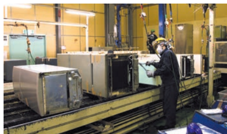
▲硬い部品や有価性の高い部品は手作業で解体
