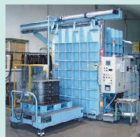
Heリーク試験装置《概要》 ■対象製品 / ガス絶縁開閉装置 ■装置寸法 (m) / W3.8×D2.0×H3.0 ■試験用ガス / Heガス (SF 6 ガス不要) ■リーク感度 / 10 -6 (Pa・m 3 /sec)
