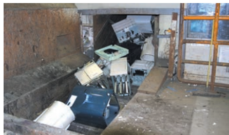
▲洗濯機の自動破砕処理ライン
