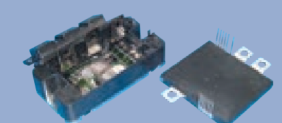
▲トランスファーモールド型(右)は64×56×7.5mmで重さ100g。従来のケースタイプ(左)に対し、容積比で1/5以下、重量比で1/3以下を実現した。
